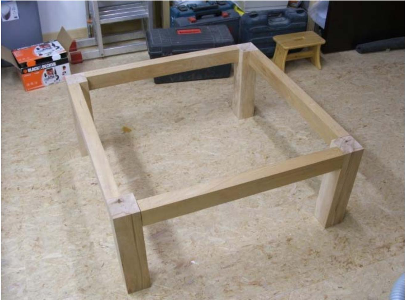
Vor dem Verleimen mussten noch die Schlitz für die Nutklötzchen in die Zargen gefräst und die einzelnen Bauteile mit dem Putzhobel ein letztes Mal bearbeitet werden.
