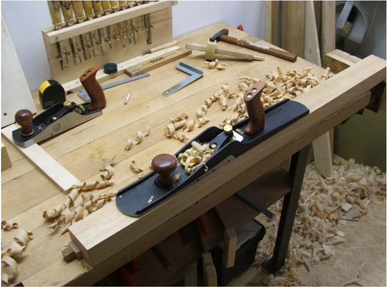
Mir dem fein eingestellten Bevel-up-Jointer wurde dann die Rechtwinkligkeit der einzelnen Seitenflächen zueinander hergestellt. Dies ging erstaunlich leicht, da der Hobel sehr präzise verarbeitet und einstellbar ist.
