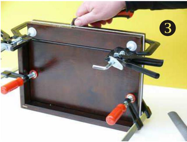
Nun werden die beiden Bündigleisten angesetzt und mit 2 Zwingen fixiert.
