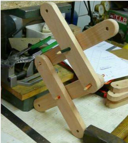
Als Länge der einzelnen Segmente wurden 250mm gewählt. Diese wurden aus einer stabverleimten 18mm Buchenplatte mit einer TKS zugeschnitten. Mit einer Dekupiersäge und einem Bandschleifer wurden die Rundungen ausgearbeitet.
