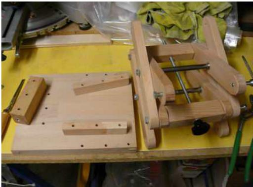
Nach den konstruktiven Überlegungen wurde das Material besorgt. Gewindestange, Rampamuffen, Maschinenschrauben, selbstsichernde Muttern, Einschlagmutter, U-Scheiben; alles M8. Rohr 12/1 mm als Abstandshalter und Buchse. Für die Auflage (280x230mm) und die Querstreben (120mm) wurde Buche 28mm, für das Lager unter der Auflage 40x40 mm verwendet.
