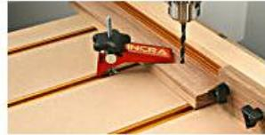
T-Nut-Schienen (T-Tracks) und weitere Komponenten des Inca Build-It Systems
