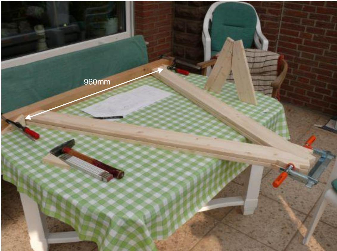
Mit einer auf 160mm Breite zugeschnittenen Hartfaserplatte konnten nun die Bohrlinien im Abstand von 160, +320 u.+320mm einfach angezeichnet werden. An der selbstgefertigten Grundplattenschablone wurde die Dübellehre angelegt. Da keine Mittellinie vorhanden war, wurden die Bohrpunkte symmetrisch an den Außenkanten der Holme ausgerichtet.
