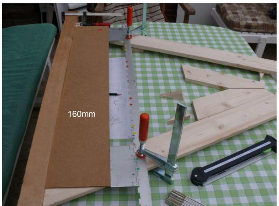
Die Dübellehre wurde mit Schraubzwingen fixiert und die 8mm- Löcher mit dem Duodübler gebohrt.
