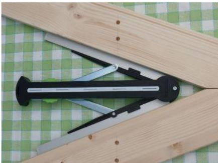
Mit der Winkelschmiege der Kapex 120 läßt sich der Schnittwinkel exakt an der Säge einstellen.
